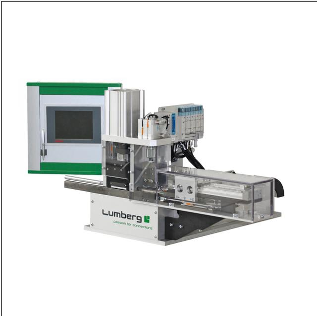
Halbautomatische Verarbeitungsmaschine für das Anschlagen von RAST-2.5-plus™-Steckverbindern in Schneidklemmtechnik (SKT), mit integrierter Leiterfarbprüfung
